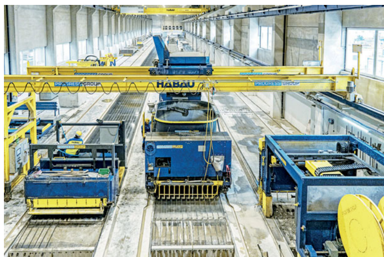
Стенды шириной 2,40 метра позволяют выпускать широкий ассортимент изделий – например, на одном стенде можно параллельно производить две плиты перекрытия шириной 1,20 метра
