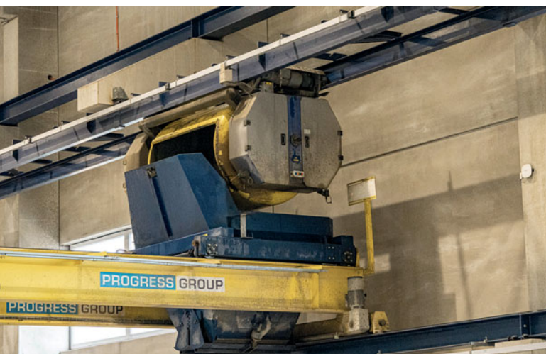
Бетонораздатчик мостового типа предназначен для автоматической подачи бетонной смеси с помощью линии адресной подачи смеси
