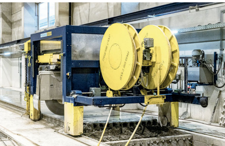
Распиловочный станок с рельсовыми направляющими производит чистые, точные пропилы в затвердевших и незатвердевших бетонных элементах
