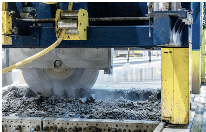
Распиловочный станок с рельсовыми направляющими производит чистые, точные пропилы в затвердевших и незатвердевших бетонных элементах
