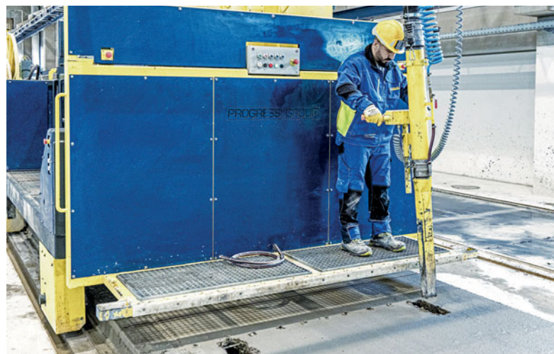
Установка отсоса бетона используется в основном для удаления бетонной смеси из углублений и отверстий
