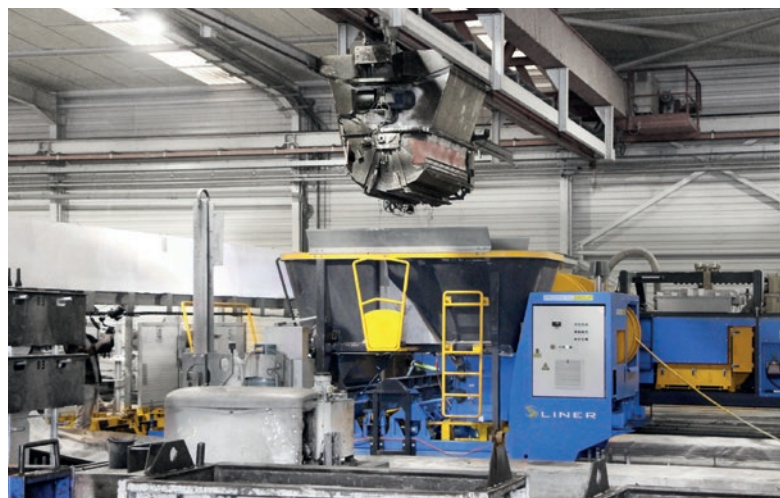
La vibrofinitrice S-Liner® garantisce una produzione automatica di lastre in calcestruzzo precompresso con meno cemento.
