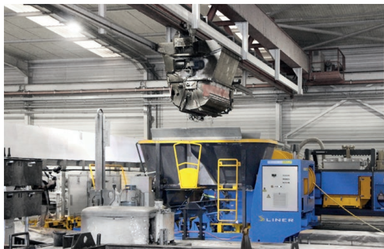
La fileuse S-Liner® assure une production automatique de panneaux en béton précontraint avec moins de ciment.
