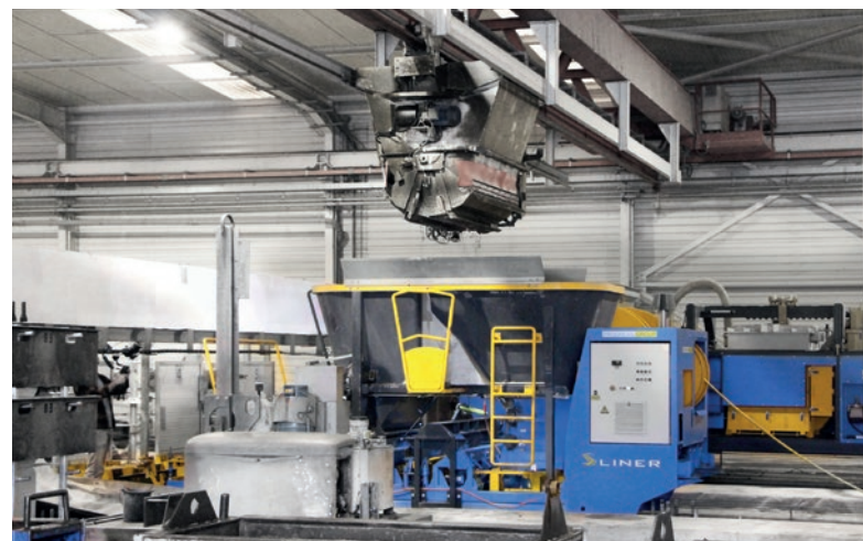
La máquina deslizante S-Liner® asegura una producción automática de placas de hormigón pretensado con menos cemento.
