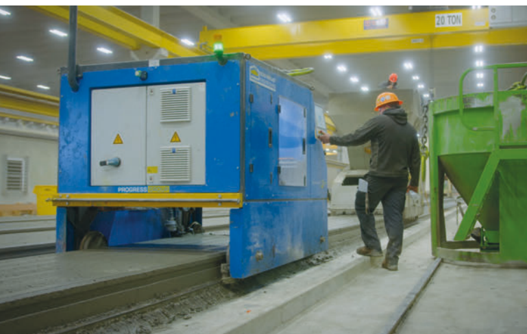
Il plotter automatico SmartJet consente di tracciare e stampare i dati sugli elementi in calcestruzzo.
