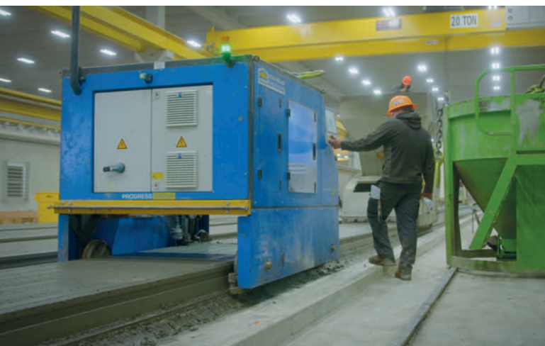
Le traceur automatique SmartJet permet de dessiner et d'imprimer des données sur les éléments en béton.
