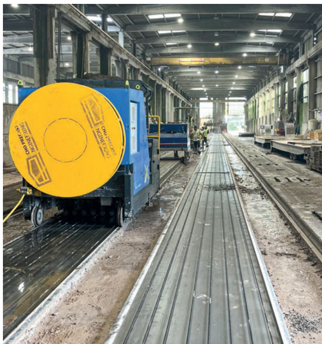
Пустотные элементы изготавливаются на дорожках шириной 1,2 и длиной 150 м
