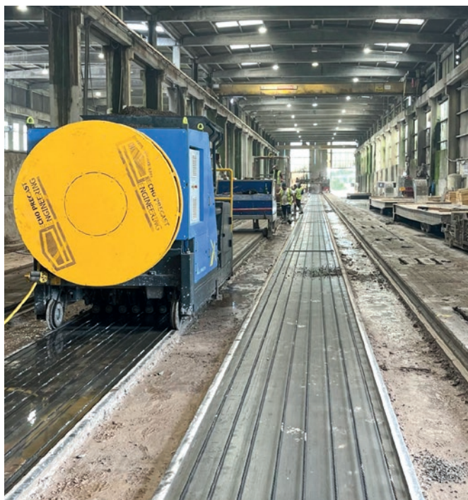
Płyty kanałowe są produkowane na torach o szerokości 1,2 m i długości ok. 150 m.
