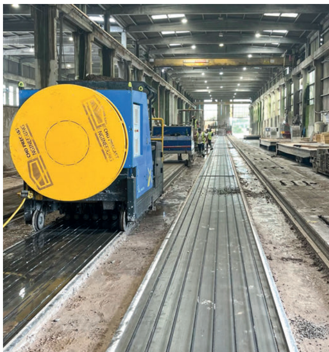
I solai alveolari in calcestruzzo precompresso vengono prodotti su piste di 1,2 m di larghezza e 150 m di lunghezza.
