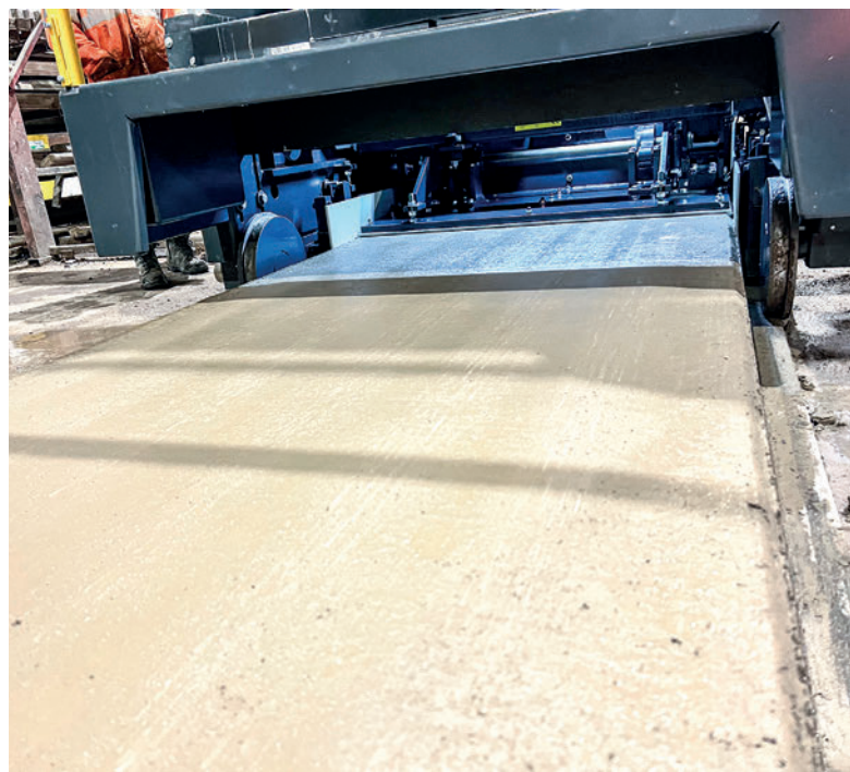
Il calcestruzzo viene pressato direttamente nella pista di produzione e resta dietro la macchina per l'indurimento.
